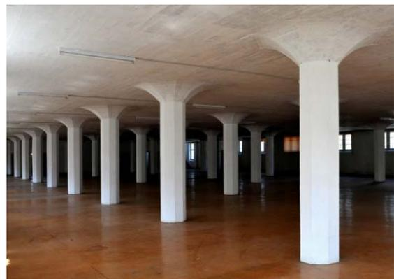
Abbildung 1: Eidgenössisches Getreidelager mit unterzugsloser Pilzdecke, Altdorf, 1912
